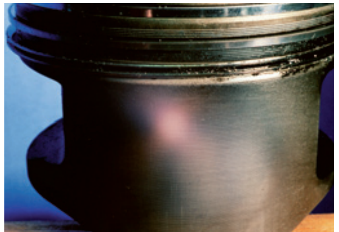
Nahaufnahme eines Kolbens. Auf dem Kolbenhemd sind noch sämtliche Bearbeitungsriefen zu sehen, ebenso an den Ringstegen.
