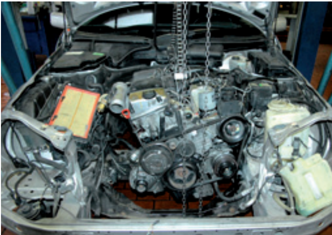
Mit einem Kettenzug wird der Motor aus dem Fahrgestell gehievt.
