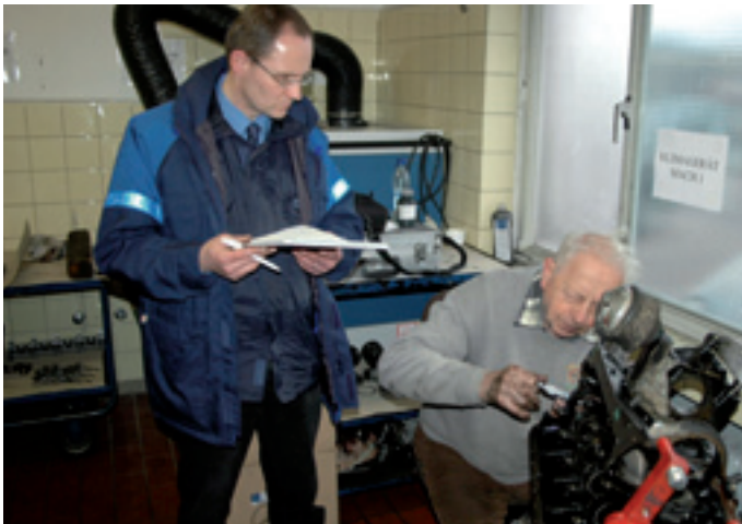
Präzisionsmessung von Motorteilen mit einem Bügelmikrometer. Dipl.-Ing. Thomas Braun vom TÜV NORD notiert die Maße.
