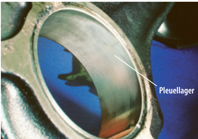
Nahaufnahme eines Pleuellagers. Die Lagerschale weist keinerlei Riefen auf - ein Beweis für optimale Schmierung.
