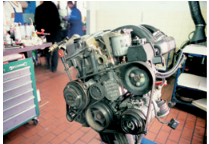
Der Motor ist auf dem Montagebock befestigt und wartet auf die Demontage.
