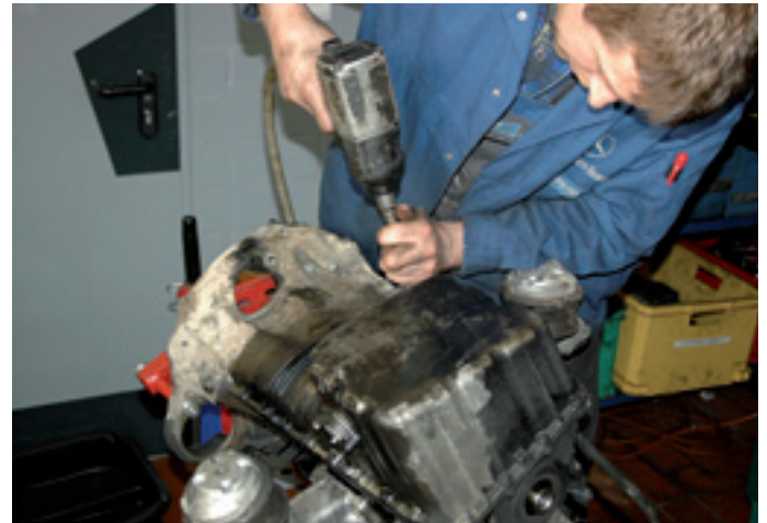
Der Monteur hat den Motor gedreht und macht sich nun daran, die Ölwanne abzubauen.
