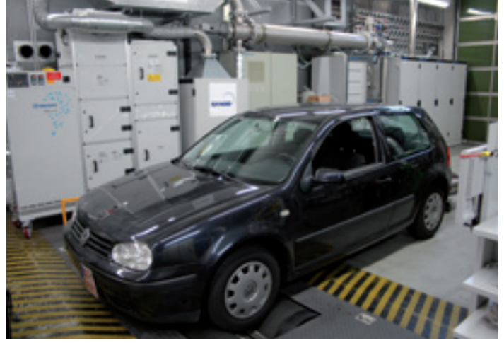
Der Golf auf dem Rollenprüfstand.
