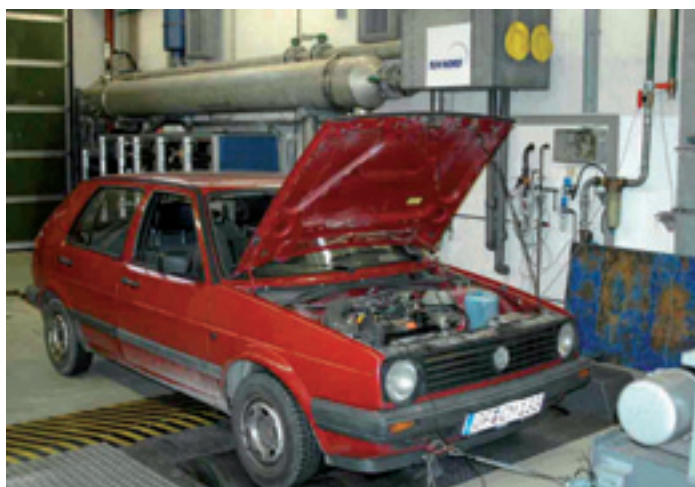
Der Golf II auf dem Rollenprüfstand
