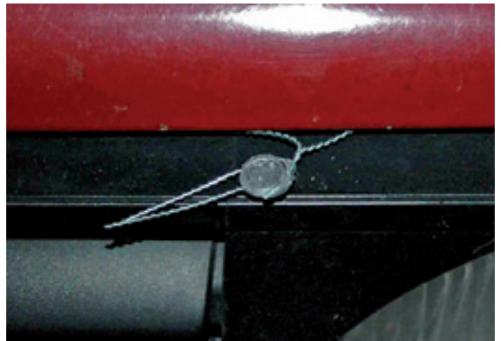
Verplombung des Motorraums
