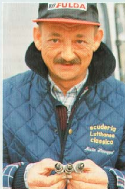
Wie aus dem Lehrbuch: Rehbraune Kerzen bestätigten dem Barkas optimale Verbrennung
