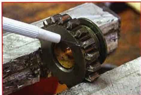
ZAHNAUSFALL Wer's beim Einlegen des Rückwärtsgangs krachen lässt, ruiniert die Zähne des Gangrads
