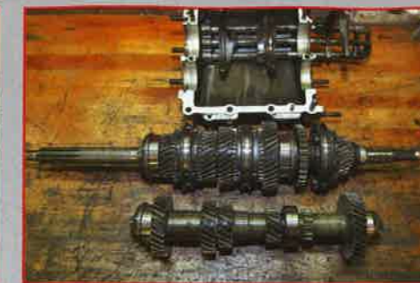
DAS INVENTAR Vorn die Vorgelegewelle, mittig die Hauptwelle, dahinter das Gehäuse mit Schaltstangen
