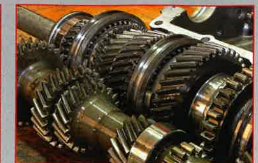
ROMEOS GEBISS Bis auf den Rückwärtsgang (vorne rechts) sind alle Gänge hypoidverzahnt
