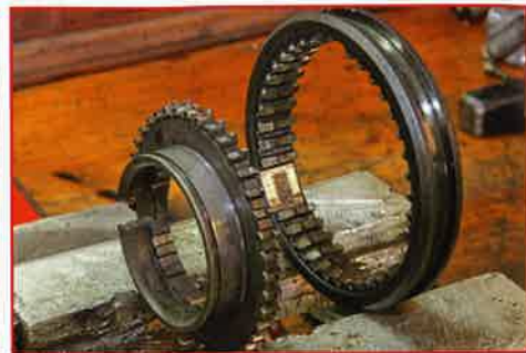
ZAHNWEH Brutales Schalten geht auf die Gesundheit von Synchronkörper und Schiebemuffe
