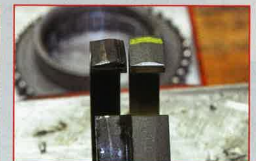
GUTER ERSATZ Links ein alter Synchronring, rechts das nach Originalspezifikation gefertigte Ersatzteil
