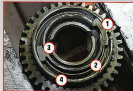
DIE SPERRSYNCHRONISATION Gleitstein (1), Sperrband (2), Sperrstein (3) und Synchronring (4)
