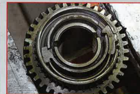
SO FUNKTIONIERT'S Die Wirkung des Synchronrings wird durch den Druck des Sperrbands unterstützt
