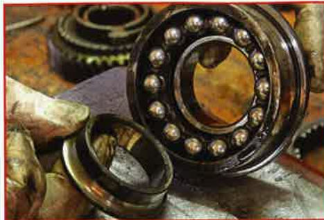
LAGERSCHADEN Wenn die Hauptlager heiß laufen, werden die Oberflächen der Laufflächen angegriffen
