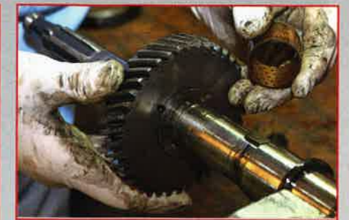
ZÄHNEKLAPPERN Wenn das Gangrad auf der Welle kippelt, ist die Messing-Lagerbuchse verschlissen
