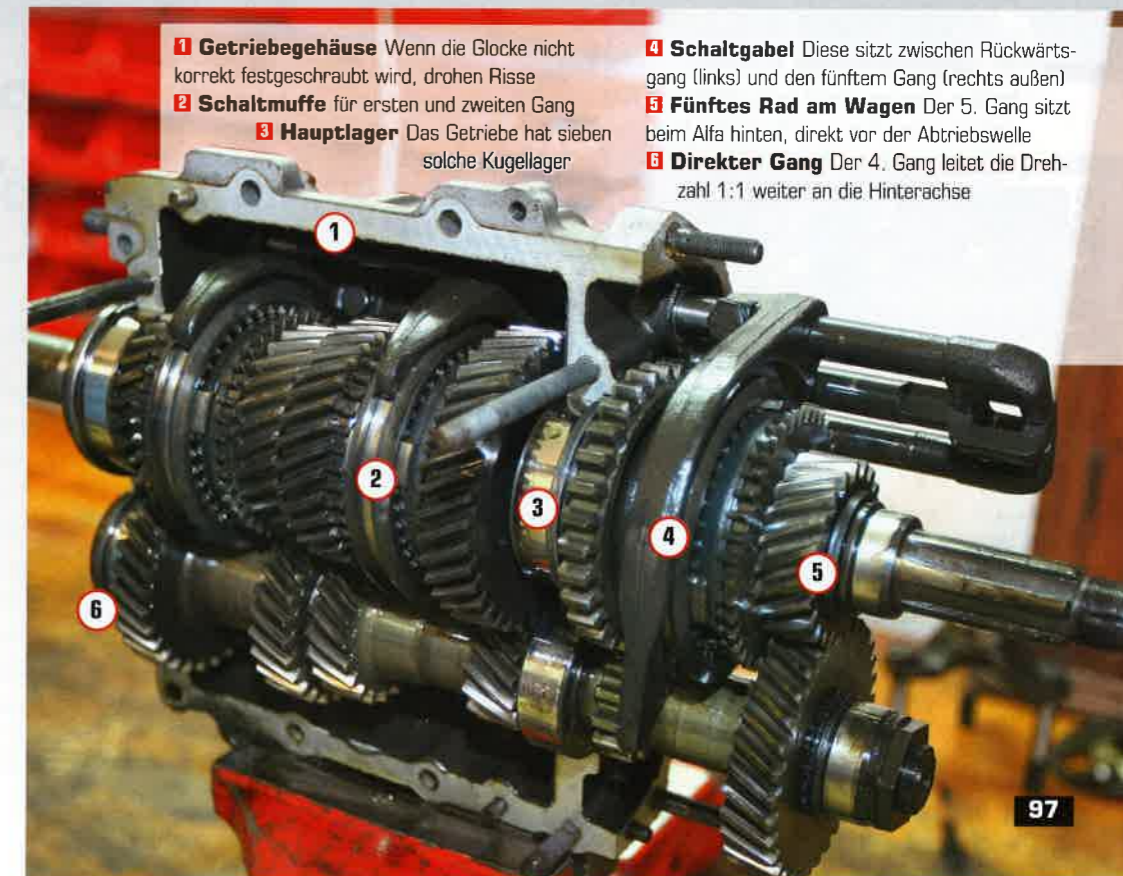
SO FUNKTIONIERT'S Die Wirkung des Synchronrings wird durch den Druck des Sperrbands unterstützt
