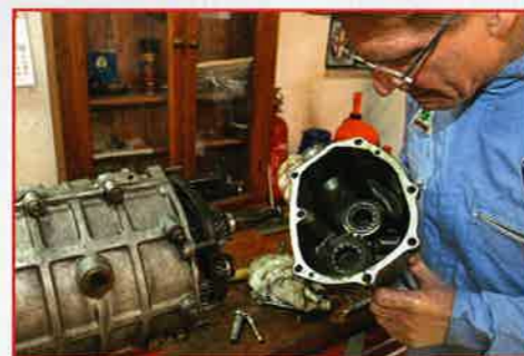
MUND AUF! Im Gehäusedeckel sind die Lagerschalen der Haupt- und der Vorgelegewelle zu sehen
