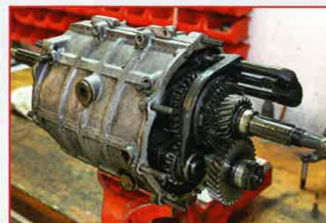
HERAUSRAGEND Fünfter Gang (vorne) und Rückwärtsgang samt Schaltgabel liegen nun bereits frei
