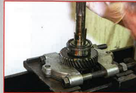
ZÄHNE ZIEHEN Mit einem Spezialwerkzeug werden die Gangräder von der Hauptwelle gepresst
