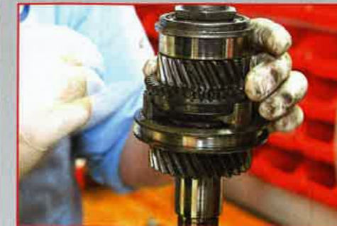
DER AUFBAU Von unten nach oben: 3. Gangrad, Schaltmuffe, Synchronring, Synchronkörper, 4. Gangrad
