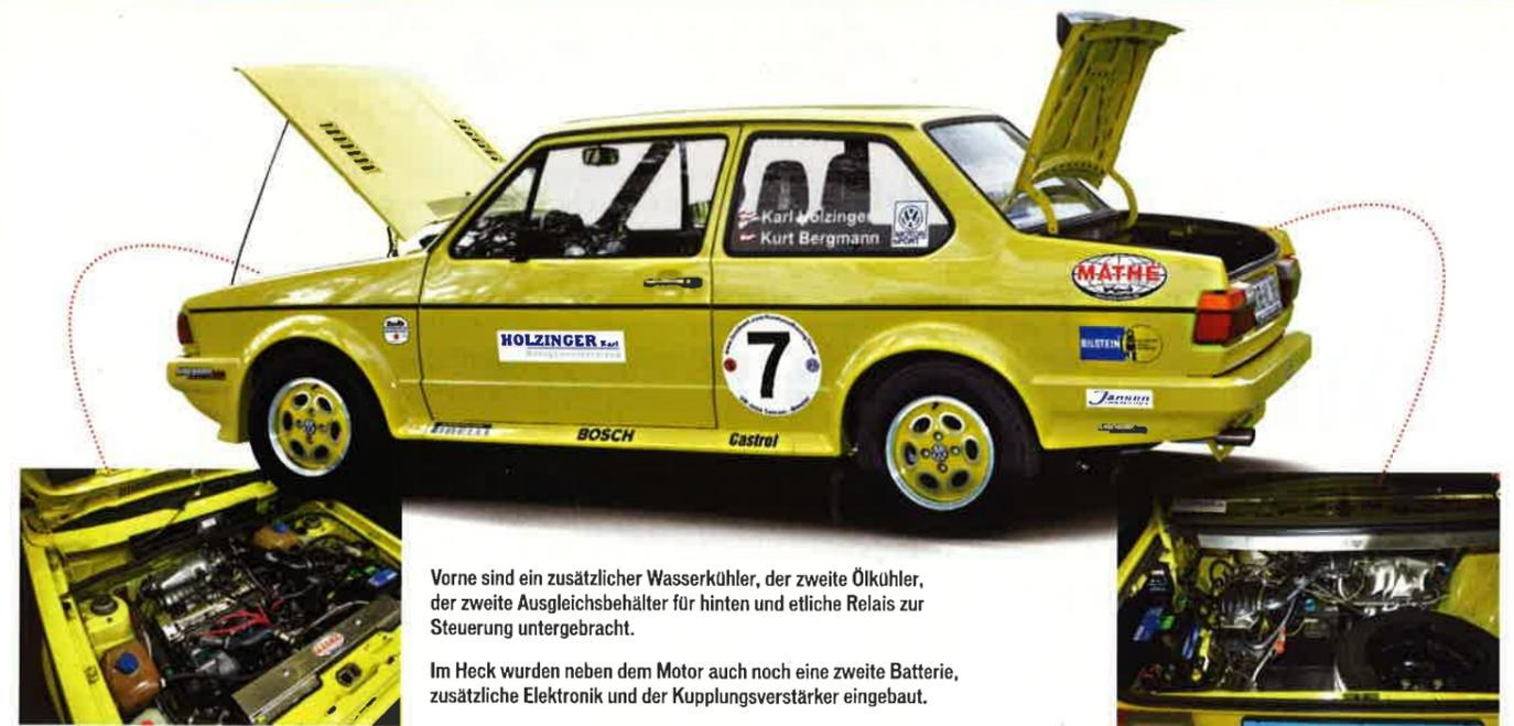
Vorne sind ein zusätzlicher Wasserkühler, der zweite Ölkühler, der zweite Ausgleichsbehälter für hinten und etliche Relais zur Steuerung untergebracht.
