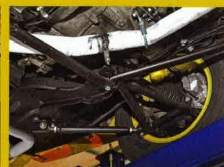
Vorderachs-Rennaufhängung nach Bergmanns Super-Vau-Konstruktion, hier zwecks Hinterachstauglichkeit stabilisiert.
