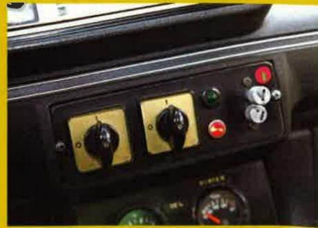
Zwei Drehschalter zwecks wahlweiser oder gemeinsamer Motor-Aktivierung per Relais. Ebenso (helle Knöpfe) können die Getriebe wahlweise entkoppelt werden.
