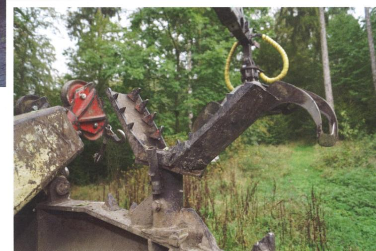
Selbst montierte Stammholzaufgabe mit einem Hydraulikschlauch als Rückholfeder
