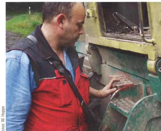
Um leichter seinen Arbeitsplatz einnehmen zu können, hat Sprenger eine versetzte zusätzliche Stufe angeschweißt.
