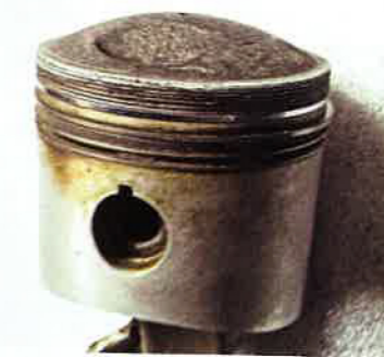
Die beiden oberen Kolbenringe sorgen für die Abdichtung zum Brennraum, der untere Abstreifring wischt das Öl von der Zylinderwand.
